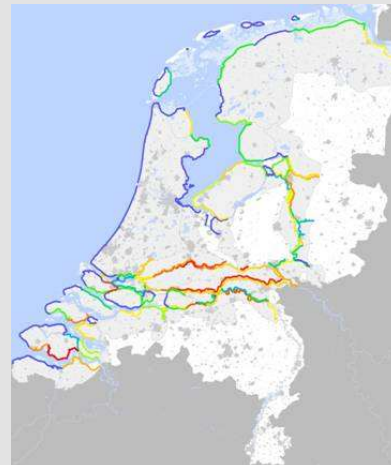
Figuur 1: Opgave van in 2022 bekende benodigde dijkversterkingen tot 2050. De dijken aangegeven met de blauwe lijnen zijn in orde. De andere kleurcodes geven de mate van benodigde versterking aan. Hierin is nog geen rekening gehouden met de mogelijkheid om taaie dijken aan te leggen
