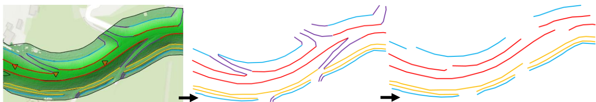
Figuur 12: Illustratie van kniklijnen vóór en na filtering van overgangskniklijnen op basis van oriëntatie.
