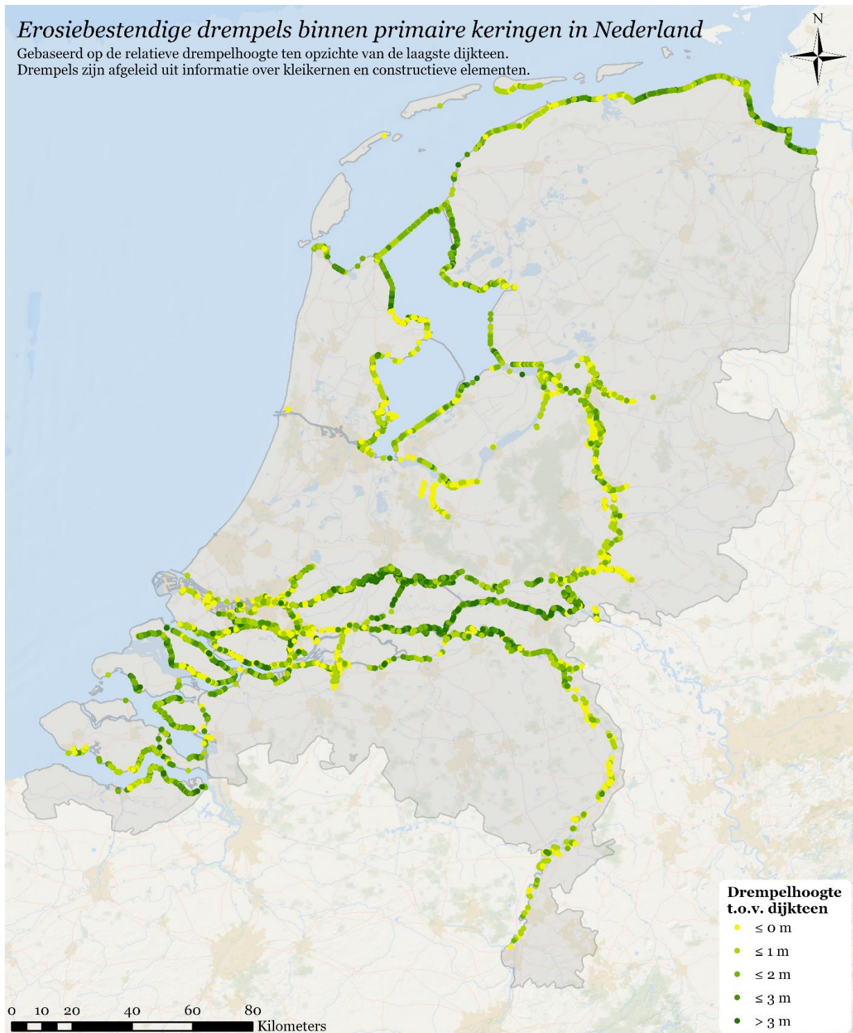
Figuur 22: Landsdekkende inventarisatie van erosiebestendige drempels in primaire waterkeringen.
