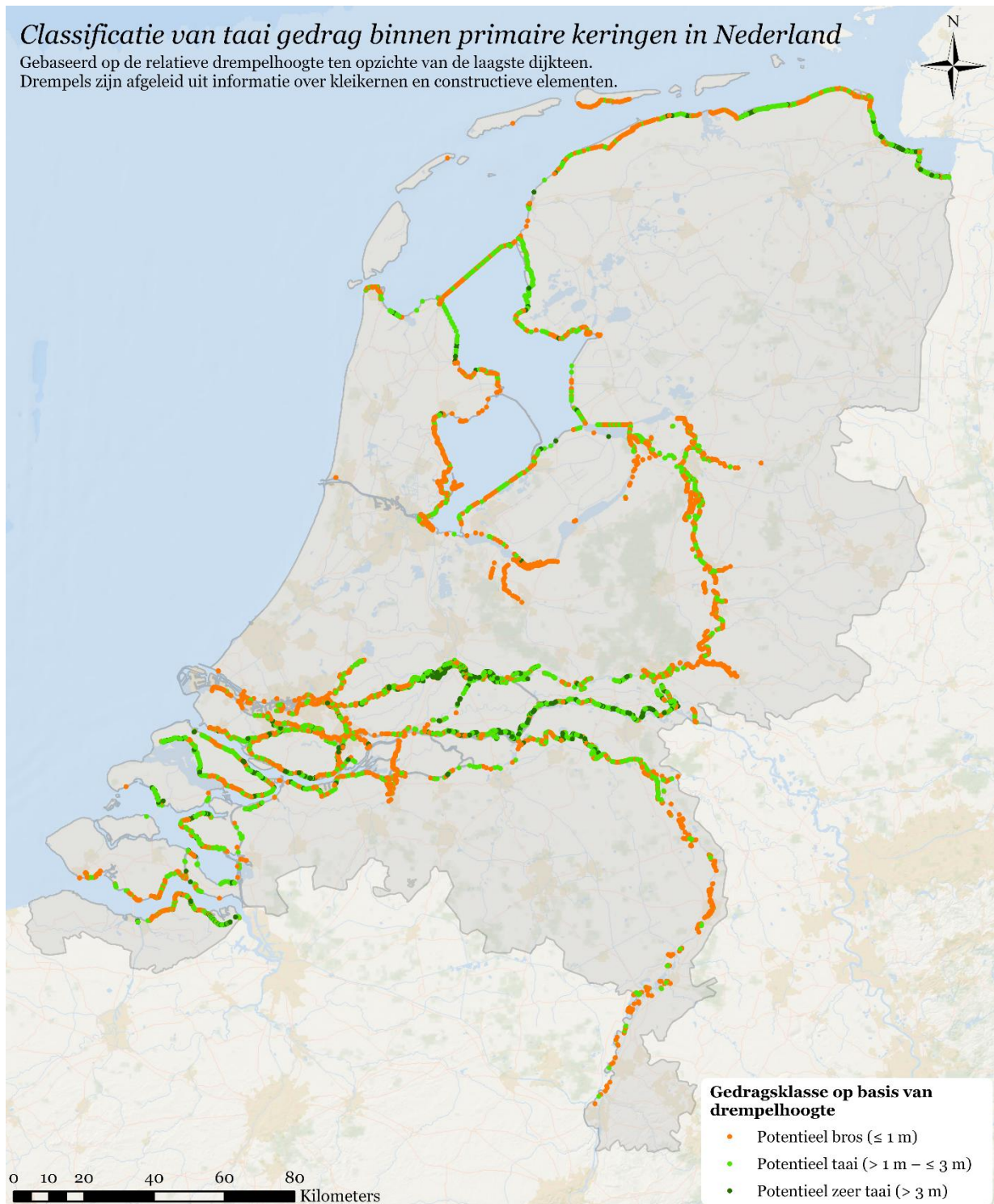
Figuur 27: De taaie dijkenkaart: een landsdekkende interpretatie van potentieel taai gedrag in primaire waterkeringen
