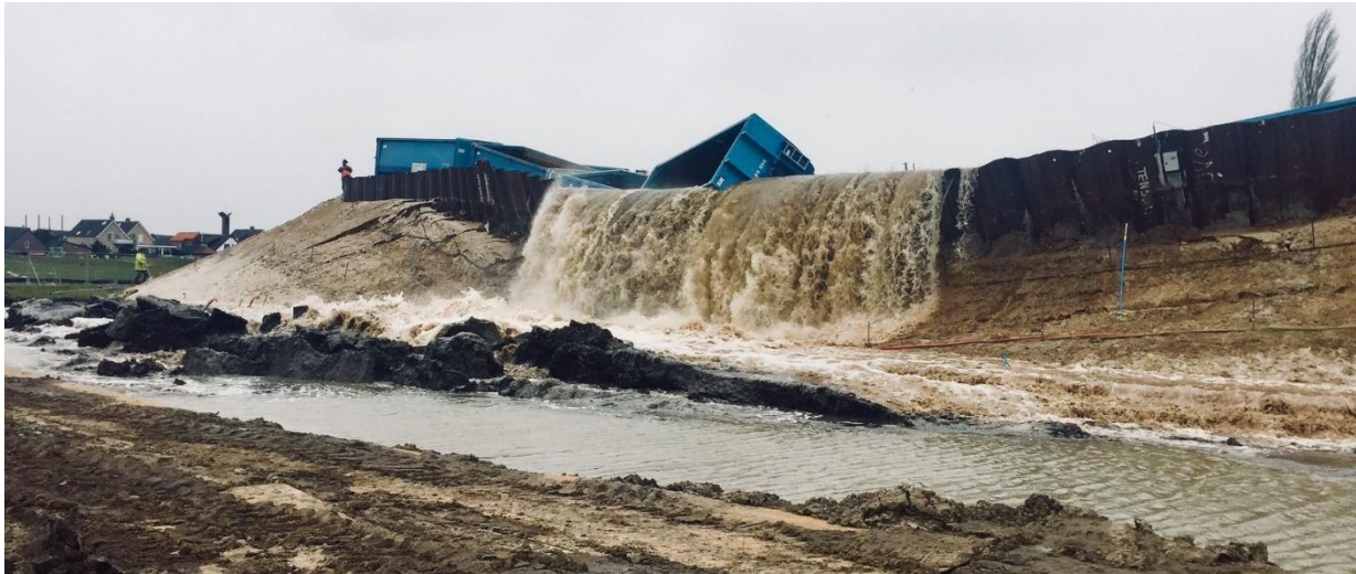
Figuur 20: Vervormde stalen damwand fungeert als drempel, Eemdijkproef (foto: POV Macrostabiliiteit).
