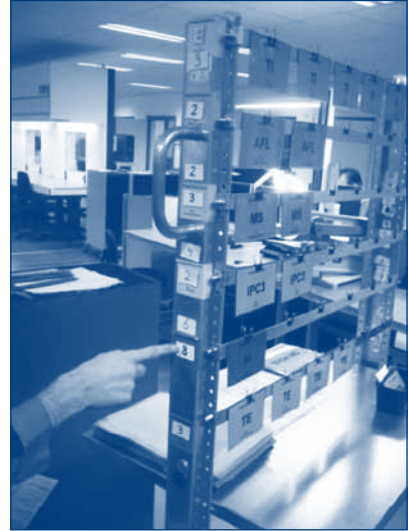
Een centraal planbord bij het bedrijf Variass te Veendam dat aangeeft hoeveel mensen in elke afdeling werken (i.e. het aantal dat de vinger aanwijst) en hoe groot de behoefte is aan nieuw werk voor die afdeling (i.e. het aantal kaarten). Ontwikkeld door de werknemers.
